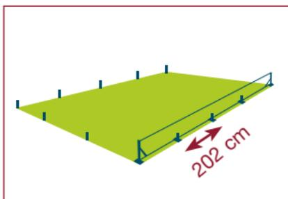
**2.** Tous les 202 cm, creusez un trou de 30 x 30 cm sur 50 cm de profondeur. Couchez le premier panneau sur le sol. Fixez-le aux deux premiers poteaux. Versez un peu de béton ( $\pm 10$  cm) dans les deux premiers trous. Placez ensuite le panneau et les poteaux dans le béton. Placez à hauteur correcte en vous basant sur la corde de niveau. Coulez du béton sec autour des 2 poteaux et tassez fortement. Ajustez l'ensemble.
