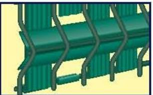
Schuif de superprofielen van boven naar onder vòòr de draden en achter de hoekprofielen. Laat de profielen rusten op de clips met het opstaande been in het superprofiel.
