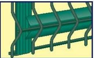
Leg de hoekprofielen in de neus van het paneel. Plaats reeds twee superprofielen of 1 m afstand van elkaar om ze vast te leggen.
