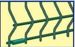
Plaats de clips op de onderste horizontale draad met het opstaande been naar boven en langs de kant van de neus.
